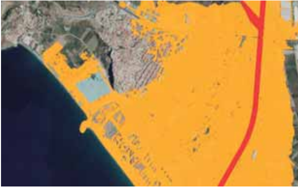
Fig. Zona inundable T-10 (que es el riesgo de inundación en periodo de 10 años) en TH-1
